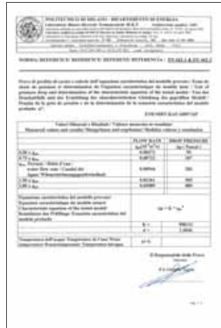
INFORME DEL ENSAYO Certificado del laboratorio MRT (Politécnico de Milán) acerca de las pruebas de: pérdida de carga.
